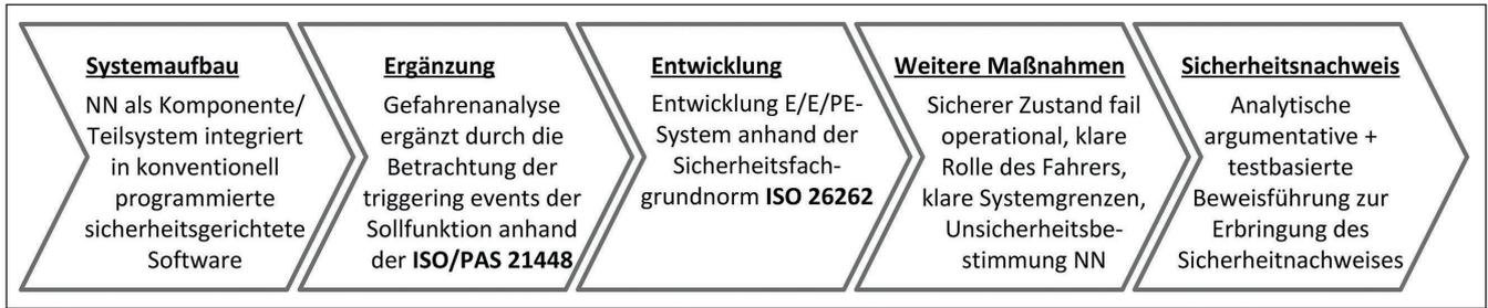
Bild 2: Konzept für den Sicherheitsnachweis Neuronaler Netze in Fahrerassistenzsystemen
